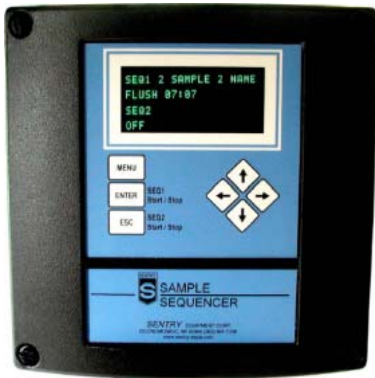
图 4 样品序列发生器前面板
